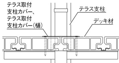
② デッキ材端部にデッキ支柱を埋設する場合、下図を参照してデッキ材を切り欠いてください。
