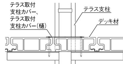
注) テラス支柱埋設位置を②の場合よりデッキ材中央側にすることはできません。テラス支柱埋設位置を変更するか、デッキ材の配置を変更してください。
